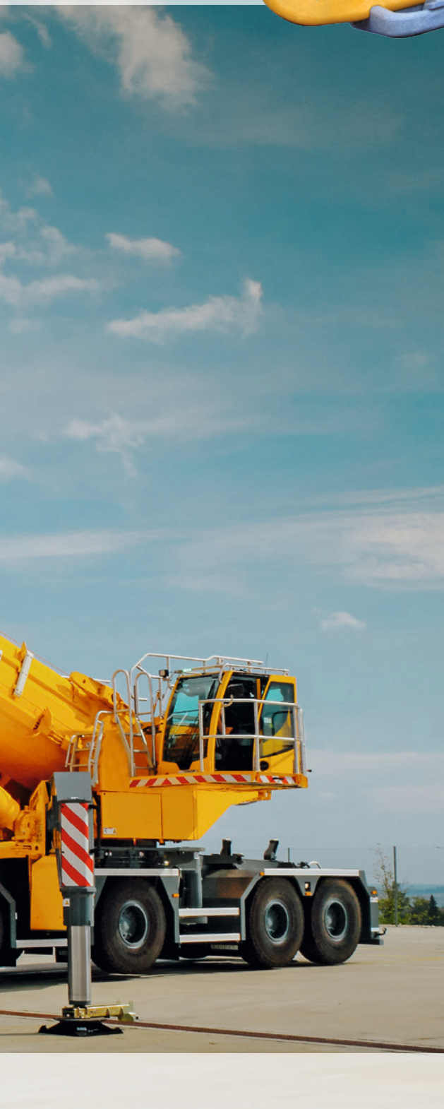
② Additional support at the tail of the vehicle Calage additionnel à l'arrière du véhicule
